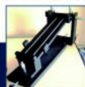
supporto con 9 gradi di libertà per reticolo eschelle
